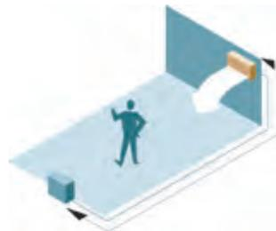
Maximale Leitungslänge je Inneneinheit von 25 m.
