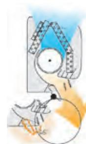
„VERTIKALER Luftstrom“ sorgt für angenehme Wärme in Bodennähe im Heizmodus
