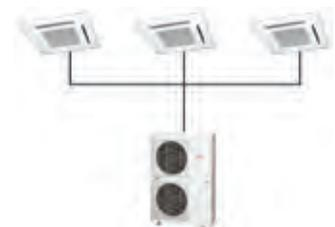
TRIPLE - Eine Außeneinheit/drei Inneneinheiten - simultan für einen Raum
