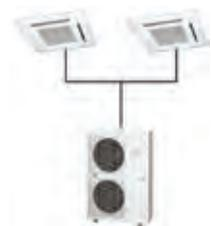
TWIN - Eine Außeneinheit/zwei Inneneinheiten - simultan für einen Raum
